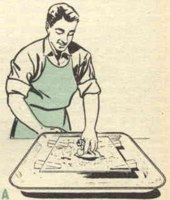
La sporcizia che si trova aderente alla superficie del vetro, viene rimossa passando su questa della polvere finissima, racchiusa in un pezzo di tela pulitissima, non molto fitta. I quattro cunei di legno, servono per facilitare il sollevamento dello specchio
